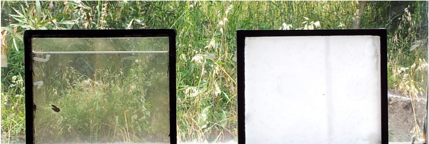
Appearance of a PCM window. Left-hand side, transparent when PCM is liquid (hot); Right-hand side, translucent when PCM is solid (cold). | Utseende på et vindu med PCM. Til venstre, transparent når PCM er i flytende form (varm); Til høyre, translucent når PCM er i fast form (kald).
